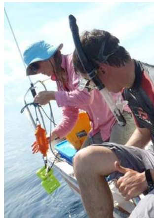
圖五 於船邊採水樣與 放置溫鹽深度儀
